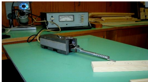
Фиг. 2.11. Електрически профилометър, модел 283 П – 69
