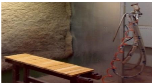
Фиг. 2.12. Пневматичен шприц пистолет за нанасяне на защитно – декоративен филм
