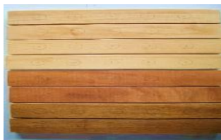
Фиг. 2.5. Пробни тела от масивна дървесина, върху които са формирани защитно–декоративни филми
