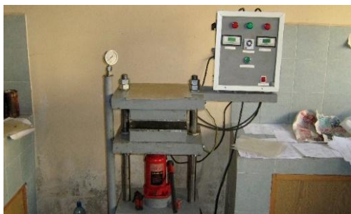
Фиг. 2.13. Лабораторна хидравлична едноцилиндрова преса
