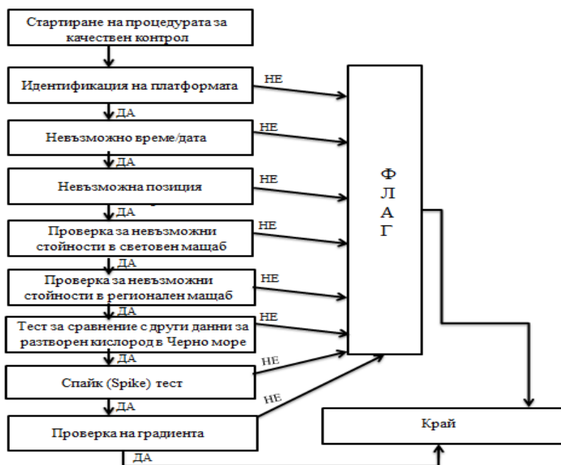
Фиг. 3.1. Последователност от стъпки на процедура за качествен контрол на данни за разтворен кислород в Черно море
